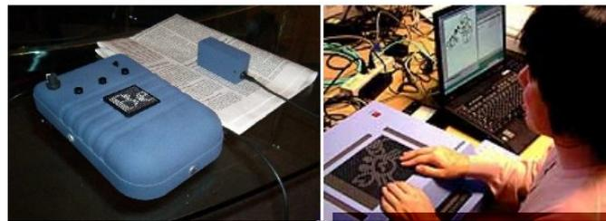
FIG. 3.23 – (gauche) : l'ADVANCED DISPLAYS for the BLIND de ABTIM ; (droite) : le DotView de KGS
