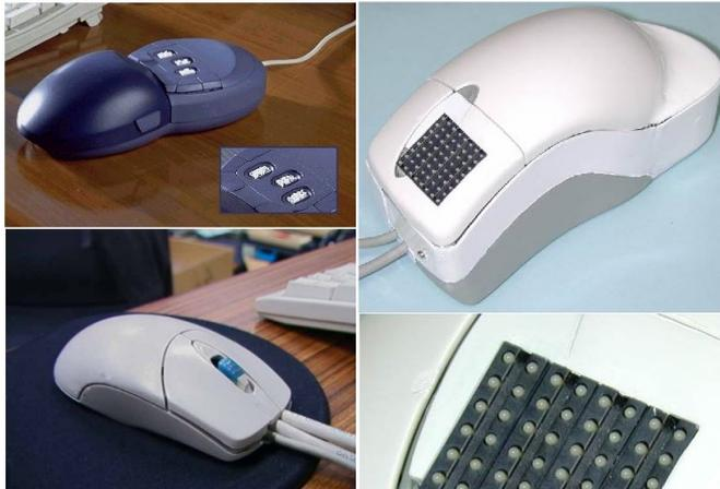
FIG. 3.24 – Le couplage des dispositifs de pointage avec le mode tactile
